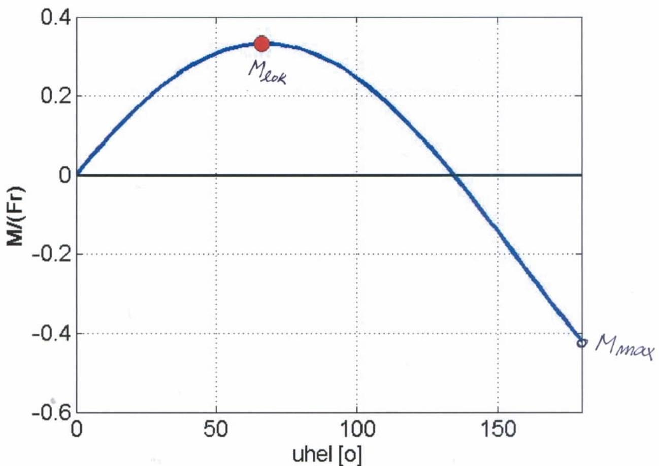
Graf vnitřního ohybového momentu v závislosti na úhlu. Moment má lokální maximum  $M_{\text{lok}}=0,33 \text{ Fr}$ , avšak maximum momentu je na ose symetrie pod silou  $F$  a to  $M_{\text{max}}=0,42 \text{ Fr}$ .
