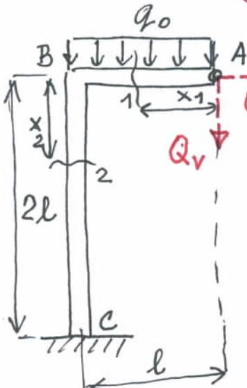
Ocelová tyč je zatížena rovnoměrně spojité silou  $q_0 [N/m]$ . Má všude stejný kruhový průřez  $\phi d$ . Určete svislý a vodorovný posuv bodu A. Použijte Castiglianovu větu.
