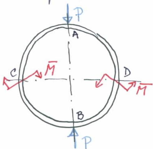
Připojení síl P zkratila úloha antisymetrie (která by odbrala 2 stupně statické neurčitosti). Získala pouze symetrii podle osy A-B. Úloha je tedy 2x staticky neurčitá.
