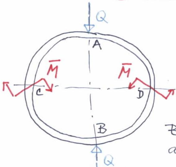
Ten řadou obruč je zatížena dvěma momenty  $\bar{M}$ . Pomoci Bettliho věty určete změnu průměru AB po zatížení.
